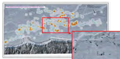
Пропарины на льду оз. Байкал как результат газопровлений
