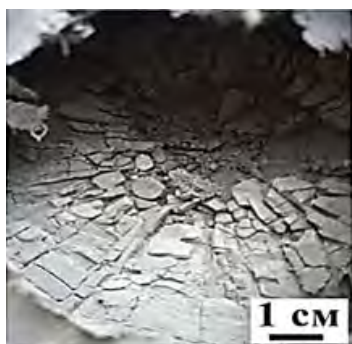
Рис. 20. Разрушение керамики «Идеал»
